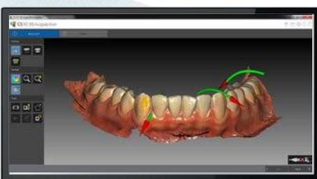
Les mises en surbrillance jaunes et vertes vous informent des manques ou des trous dans la numérisation, indiquant que la zone doit être numérisée à nouveau pour obtenir des détails optimaux.
