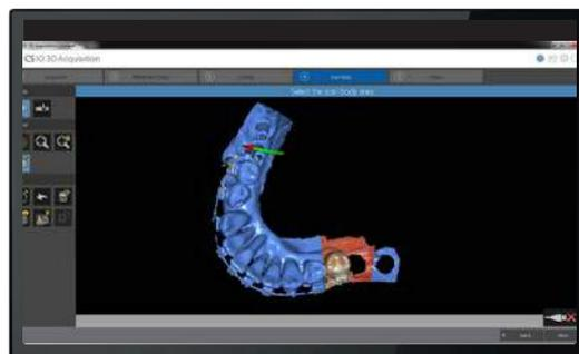
Un outil innovant de sélection de zone de numérisation permet d'éviter les erreurs d'image pouvant survenir lors de l'utilisation de plusieurs corps de numérisation sur un même cas.
